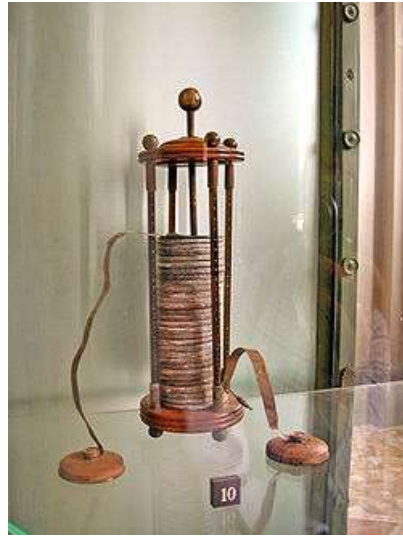
[그림 6: Voltaic Pile]
